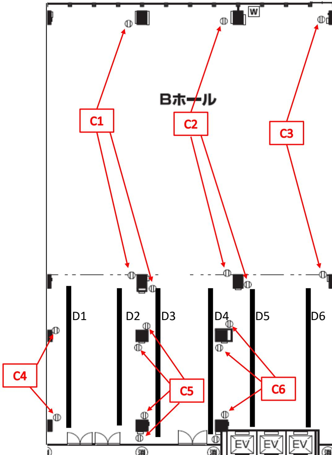
電気容量:コンセント C1~C6 1.5kw × 6回路 = 9.0kw
