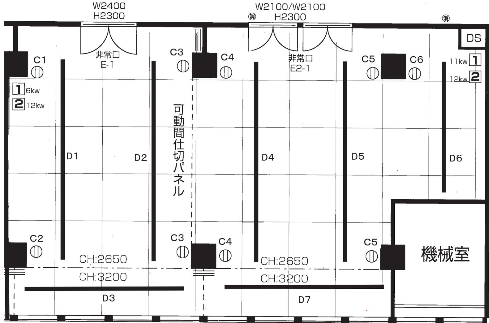
Eホール 電気容量 コンセントC1~C3 1.5Kw × 3回路 = 4.5Kw 配線ダクトD1~D3 1.5Kw × 3回路 = 4.5Kw
