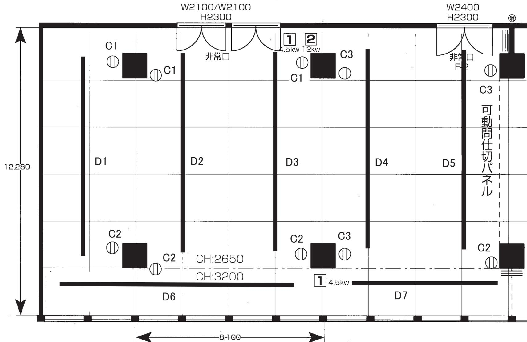
Fホール電気容量 コンセントC1～C3 1.5Kw × 3回路 = 4.5Kw 配線ダクトD1～D7 1.5Kw × 7回路 = 10.5Kw
