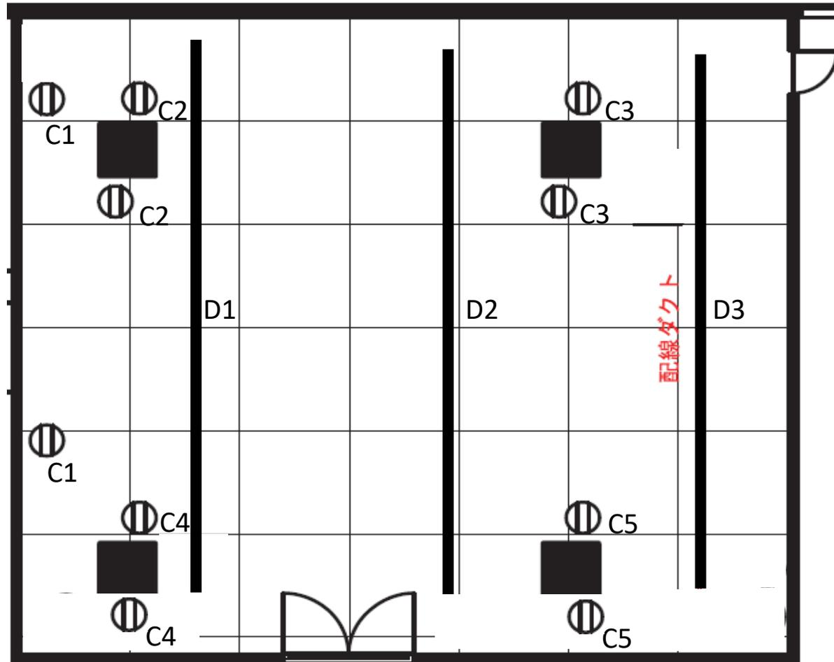
電気容量:コンセント C1~C5 1.5kw × 5回路 = 7.5kw
